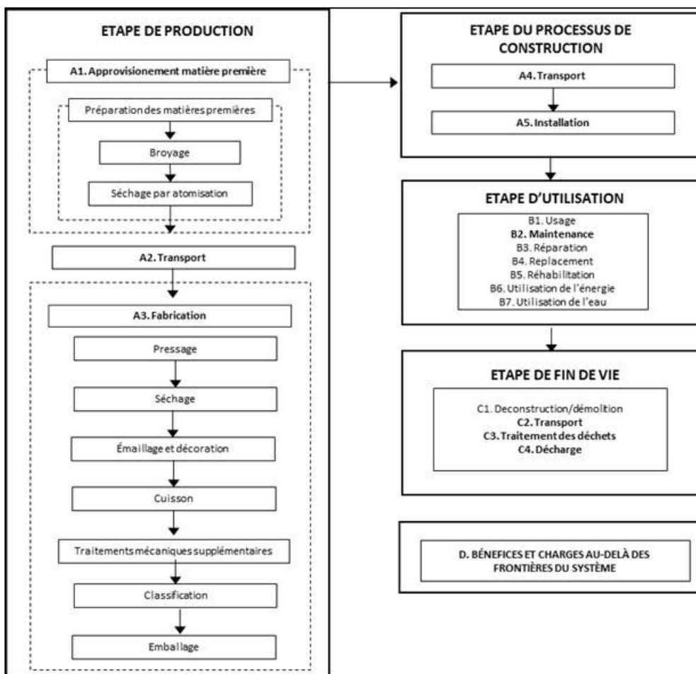
Figure 1. Diagramme avec les limites du système, les étapes et les processus pour la production d'1 m<sup>2</sup> de carreau céramique B11a 8mm - 11mm moyenne.
